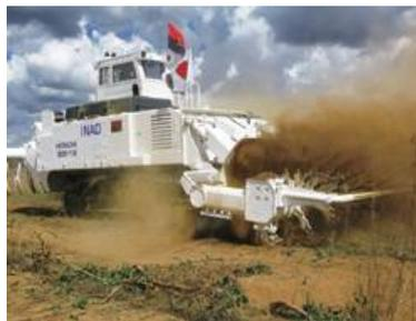
Matériel de déminage utilisé en Angola (Photo: by Yamanashi Hitachi Construction Machinery Co., Ltd.)
